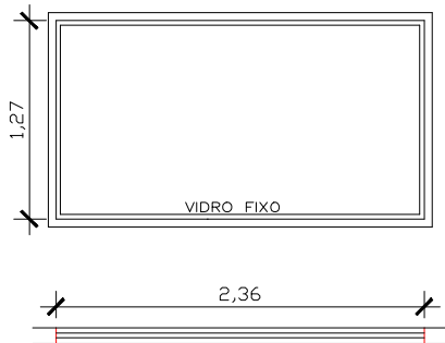
J05 ÁREA=2,99m² 1 UNIDADE Obs.: Esquadria existente; necessita ser recolocada no vão existente e colocação de 2 planos de vidro (ver detalhe).
